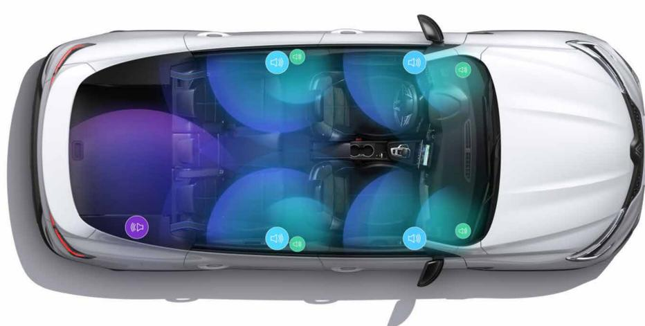
2 tweeters en los laterales del cuadro de instrumentos, 4 woofers en los paneles de las puertas delanteras y traseras, 2 tweeters en los paneles de las puertas traseras y 1 subwoofer en el maletero.
